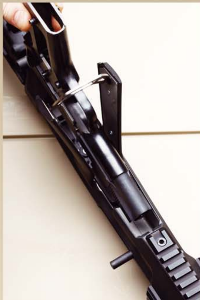
Mit dem mitgelieferten Montagewerkzeug werden die integrierten Griffschalen des CPE Systems auseinandergespreizt und eine klassische, von ihren Griffpaneelen befreite 1911 ist blitzschnell eingesetzt und verschraubt.
